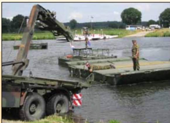
◀ en ▶ een ponton vouwbrug wordt uit het water getakeld
