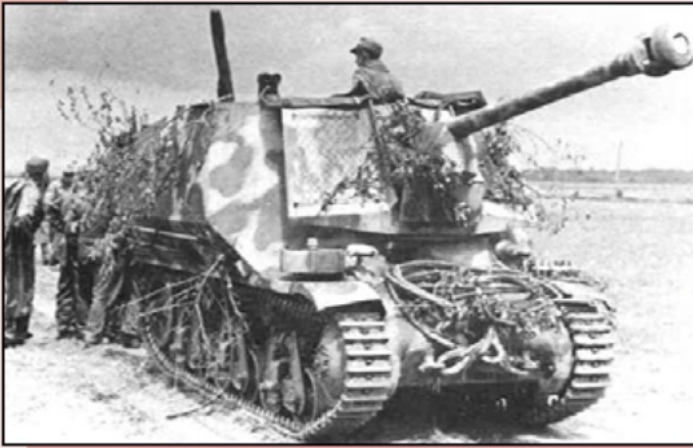
▲ Marder Hotchkiss (7,5 cm PaK 40 op Hotchkiss chassis)
