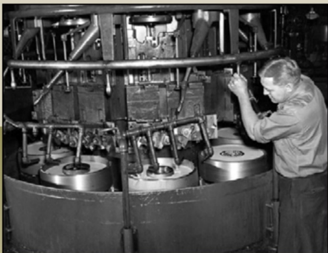
▼ De rem-/stuurtrommels worden gemaakt.
