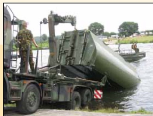
◀ en ▶ een ponton vouwbrug wordt uit het water getakeld
