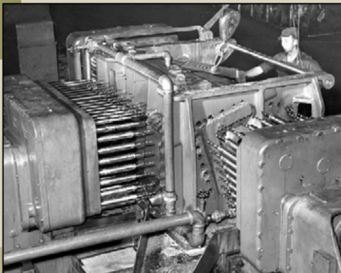
De binnenringen (zie tekening vorige pagina) worden geboord. Dit zijn de montagevlakken waar de transmissieplaat (◄) en aandrijflijn (▲) op worden gemonteerd.
